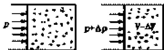
液体受压力作用发生体积变化的性质叫压缩性。液体的压缩性极小，在很多场合下，可以忽略不计。但在受压体积较大或进行动态分析时就有必要考虑液体的可压缩性。液体的相对压缩量与压力增量成正比，如图 2.1。
